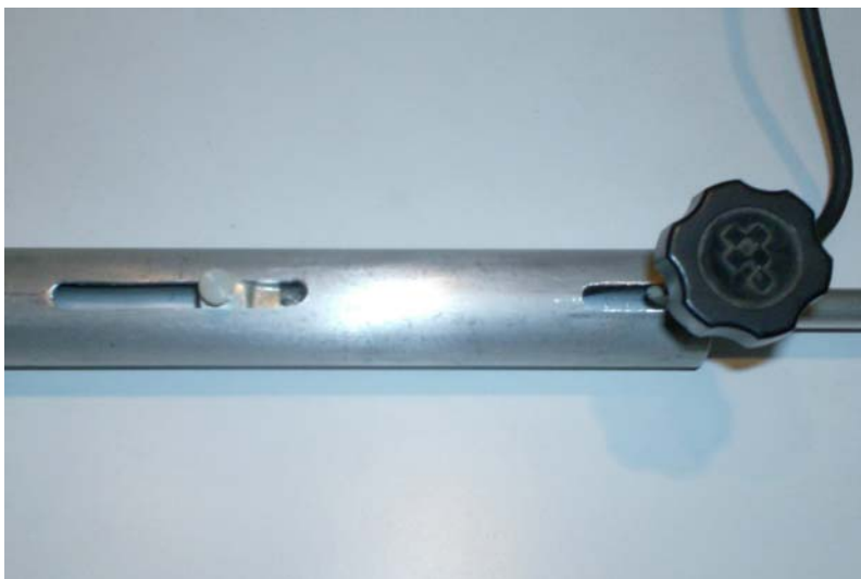
Fig. 2: lengte van stub, transmissielijn en straler zijn instelbaar
