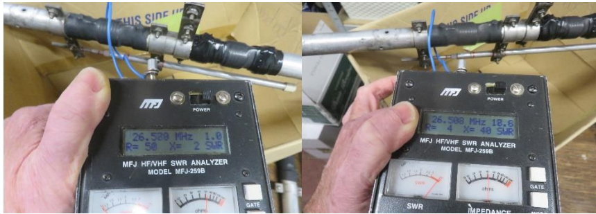
Frequentiemeting 10m trap: 1e foto met lus rond de spoel (26580 kHz), 2e foto met lus verwijderd v.d. spoel (26508 kHz, meternaald (SWR) geeft nog net een dipje)
